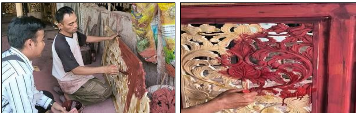
Gambar 1: Pelapisan warna dasar yang diberikan sebelum membuat pola
